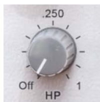
Potentiomètre de réglage de la fréquence du filtre passe-haut
