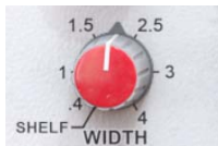
Potentiomètre de réglage de largeur de bande du filtre
