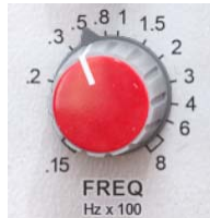
Potentiomètre de réglage de fréquence du filtre de la bande d'égalisation concernée.
