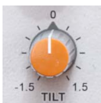
Potentiomètre de réglage de la fréquence du filtre "tilt"
